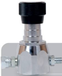
Flow Regulator P/N: AP661 Max.W.P.: 350 bar
